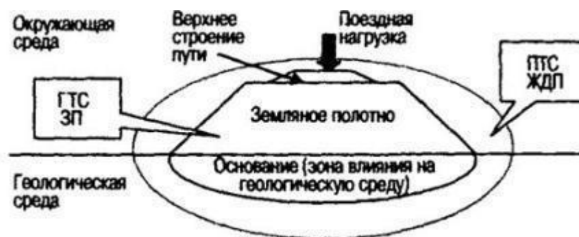
Рисунок 8 – Схема геотехнической системы «Земляное полотно» железных дорог
